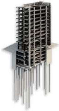
Modelo tridimensional del edificio. La profundidad de las pilas es de más de 50 m y la altura del edificio es de 44 m a partir del nivel calle.
