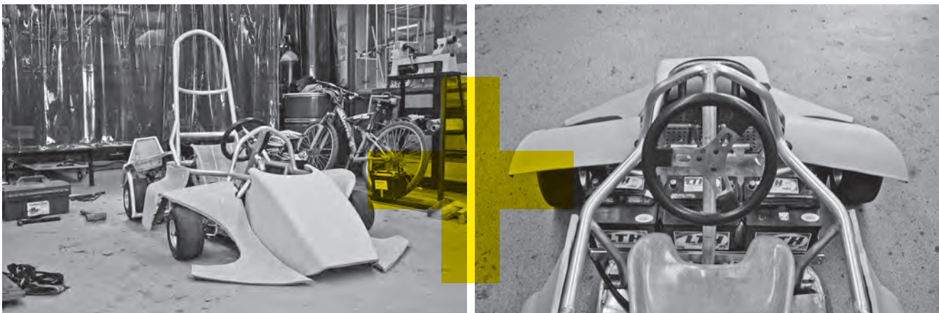
FIGURA 1. Vehículo electrátón fabricado con estructura de aluminio
